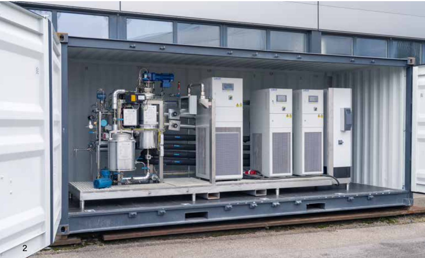
Kurzwegverdampfer-MINIPLANT zur destillativen Reinigung und (Rück-)Gewinnung von Wertstoffen © GIG Karasek
